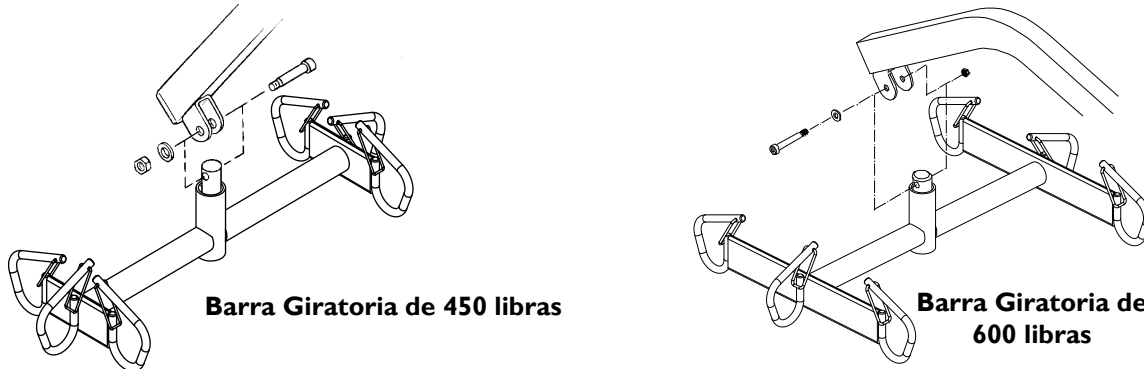
FIGURE 10.2 Reemplazando la Barra Giratoria
